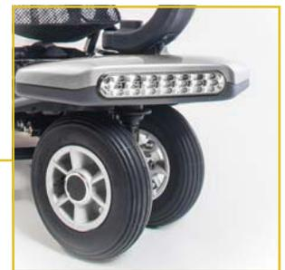
Suspensión delantera. Luces LED delanteras y traseras
